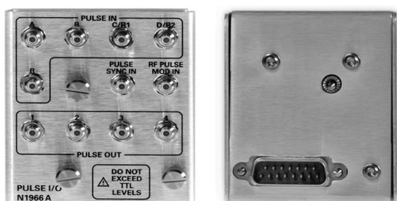
Адаптер импульсного ввода/вывода (N1966A) упрощает подключение
